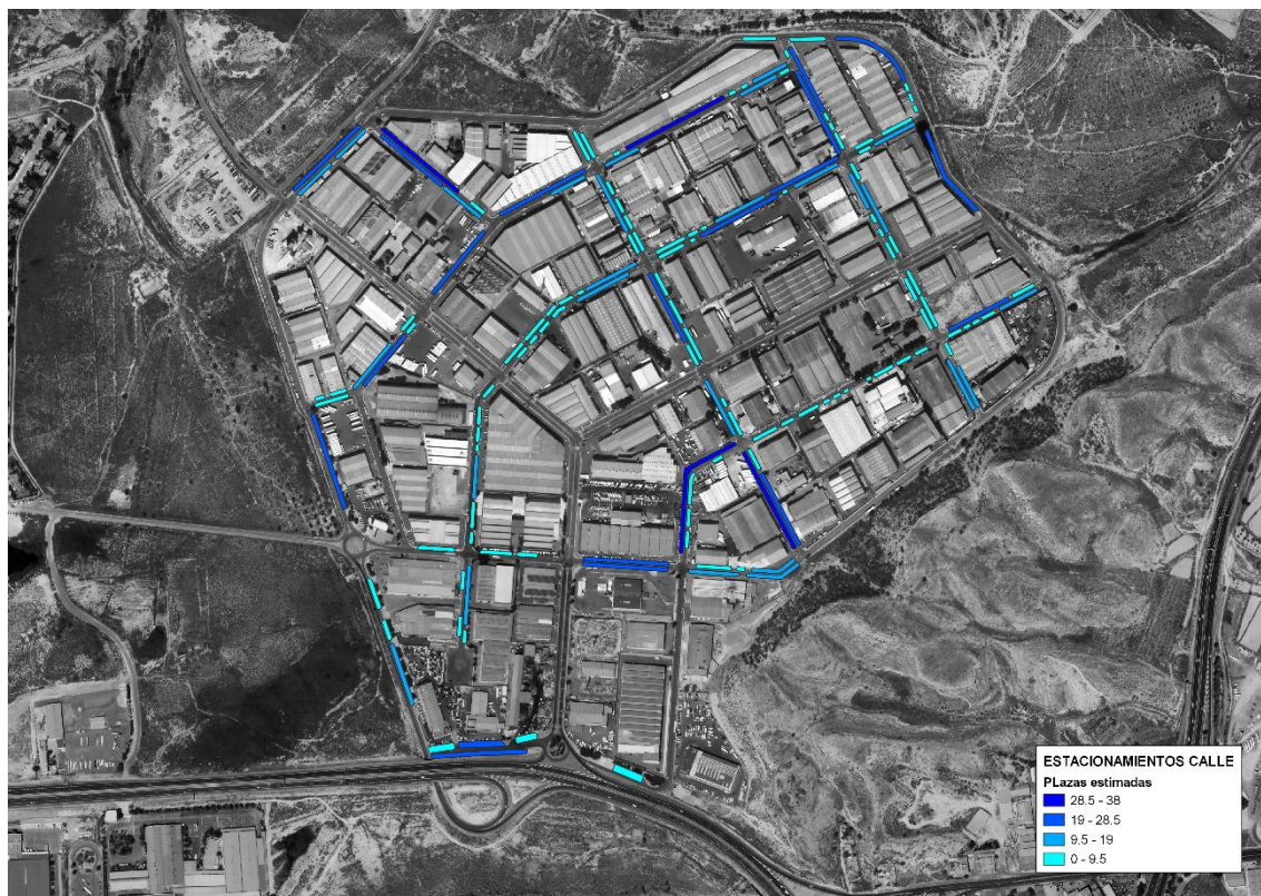
Figura 24. Plazas estimadas en estacionamientos en calle en el área industrial Pla de la Vallonga. Fuente: Elaboración propia a partir de PNOA cedido por © Instituto Geográfico Nacional.
